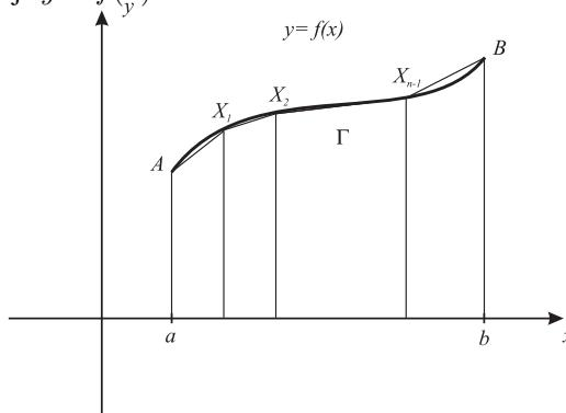
Označimo sa  $\sigma_P$  sumu dušina  $d(X_{i-1}, X_i), i = 1, 2, \dots, n$ , svih duži  $\overline{X_{i-1}X_i}, i = 1, 2, \dots, n$ , koje čine izlomljenu liniju (koja, očito, aproksimira krivu  $\Gamma$ ), tj.
